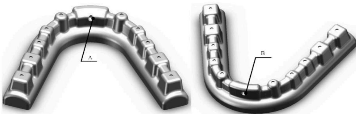
图 5 夹持力试验压力施加点示意图
