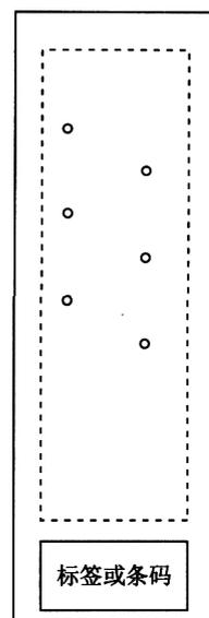
附图 2 基片接触角测试点选择示意图
