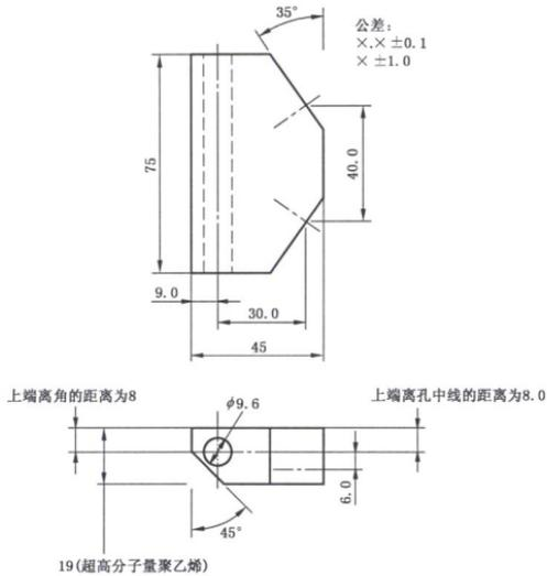
图7 螺钉或螺栓连接颈锥双侧聚乙烯块
