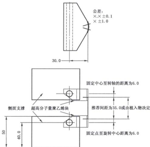
图4 螺钉或螺栓连接颈椎单侧试验结构
