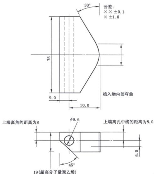
图5 螺钉或螺栓连接颈椎单侧聚乙烯块
