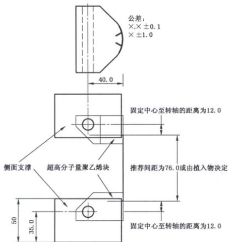
图10 螺钉或螺栓连接腰椎双侧聚乙烯块
