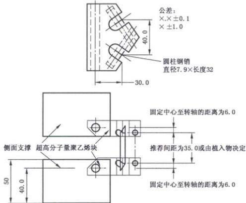
图8 钩、缆线或丝连接颈锥双侧试验结构
