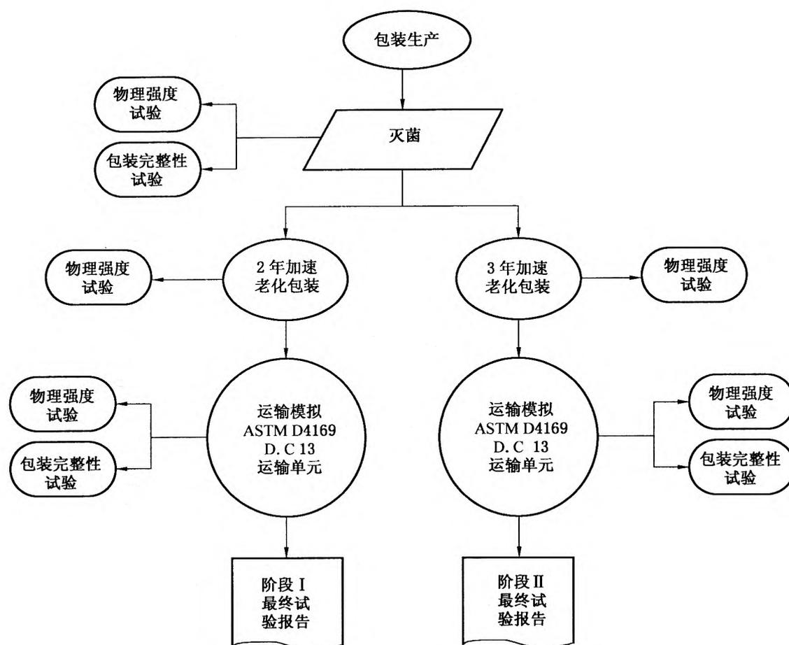
注：实际时间老化包装试验与加速老化包装试验相同。
