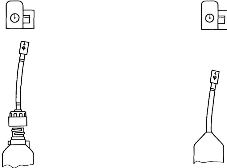
a) 带有瓶颈环的螺纹瓶颈,带有瓶连接器
