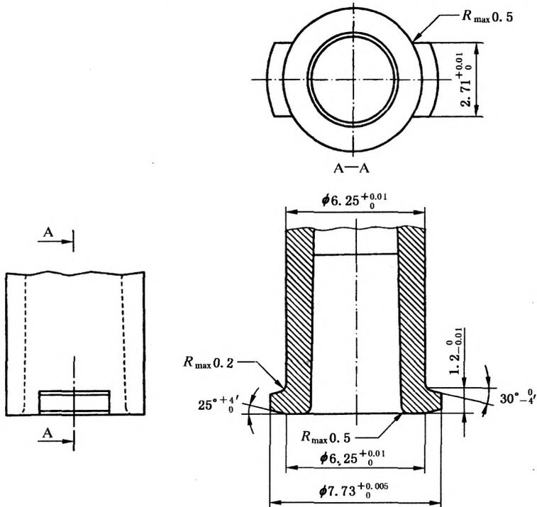
注：凸耳和螺纹部分的所有外部边缘应有 0.15 mm 至 0.2 mm 之间的半径(除非另有规定)。
