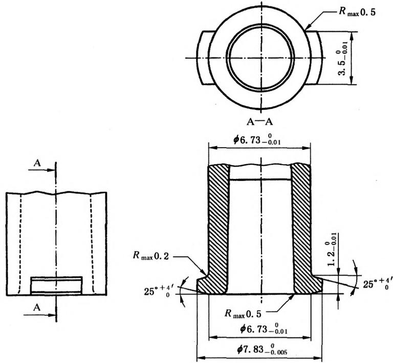
注：凸耳和螺纹部分的所有外部边缘应具有 0.15 mm 和 0.2 mm 之间的半径(除非另有规定)。
