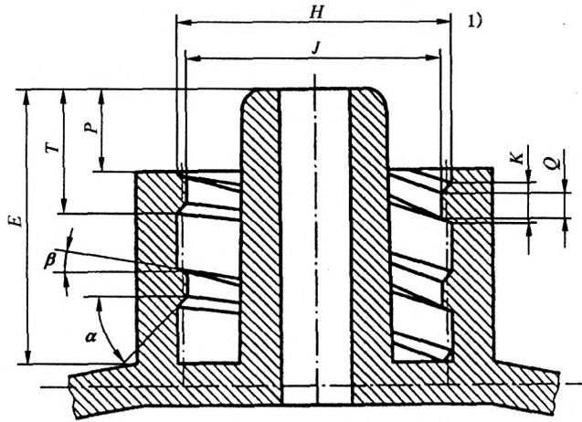
1) 双头右旋螺纹, 螺距 2.5 mm。
