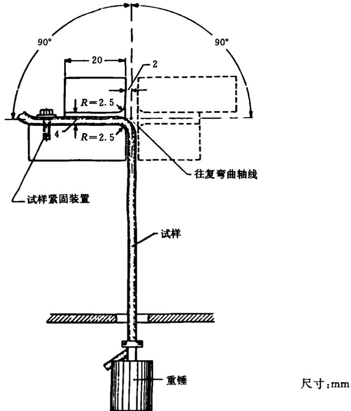
图 2 弯曲试验设备
