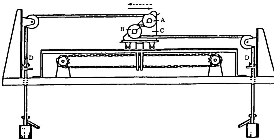
图 1 曲绕试验设备
