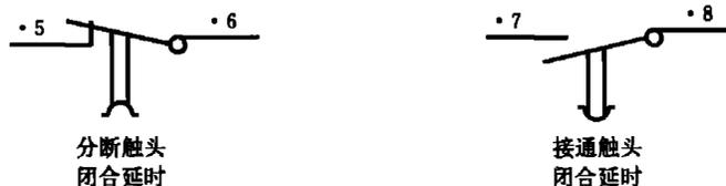
带有转换触头且转换触头具有特殊功能的接线端子应用功能数 5、6 和 8 来标志。
