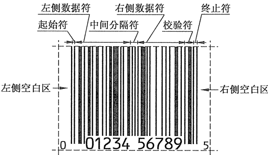
图 C.1 UPC-A 条码的符号结构
