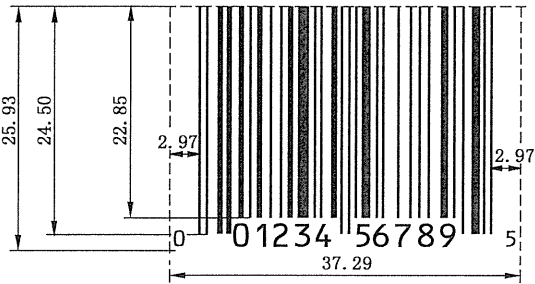
图 C.5 UPC-A 商品条码尺寸示意图(放大系数为 1.00)
