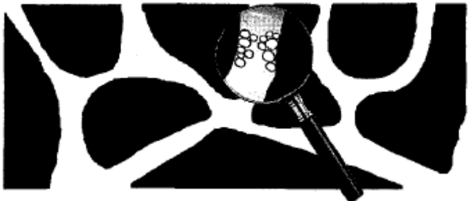
图 5.2-4 孔的逐渐堵塞
