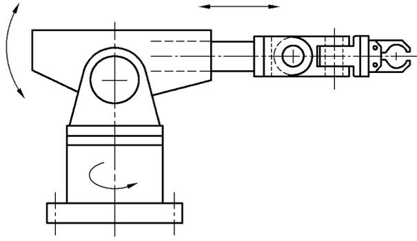
图 A.3 极坐标或球坐标机器人
