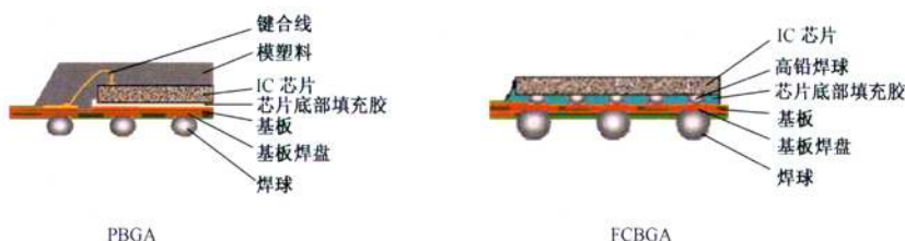
图 B.3 阵列类集成电路示意图
