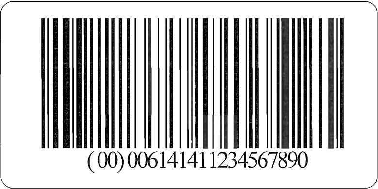
图 B.1 基本物流单元标签:一个 SSCC
