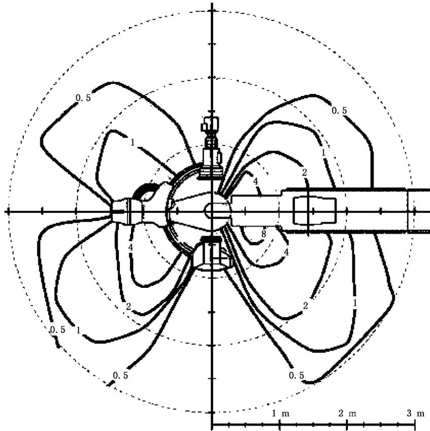
图 BB.1 设备横向位 100 cm 高度上的等比释动能图例
