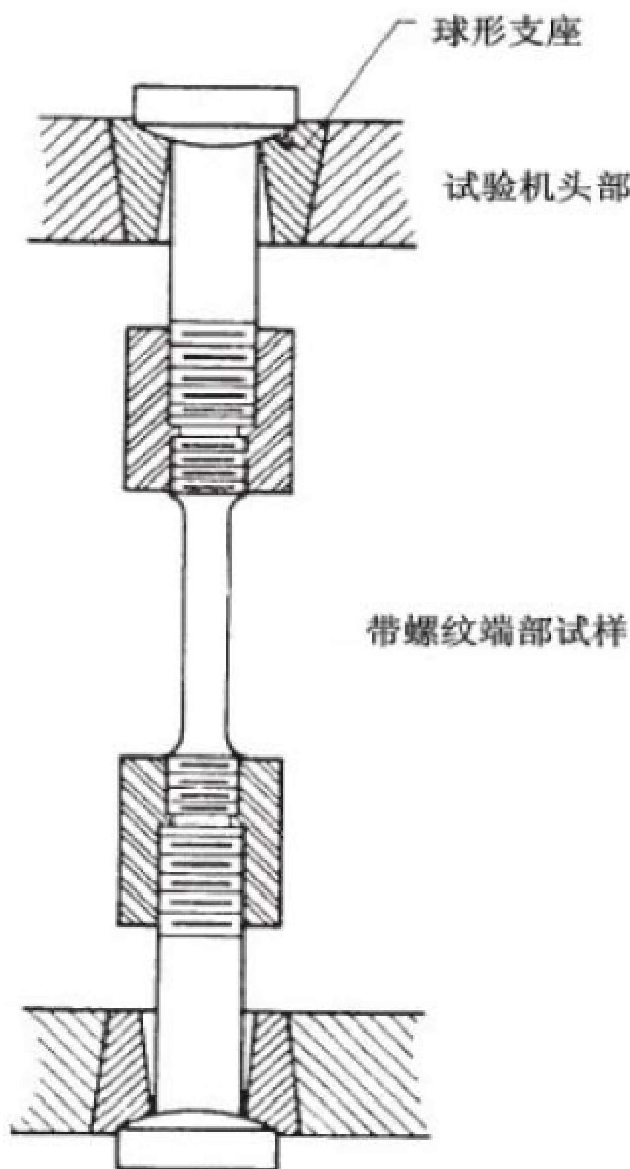
**图3 用于带螺纹端部试样的夹持装置**
