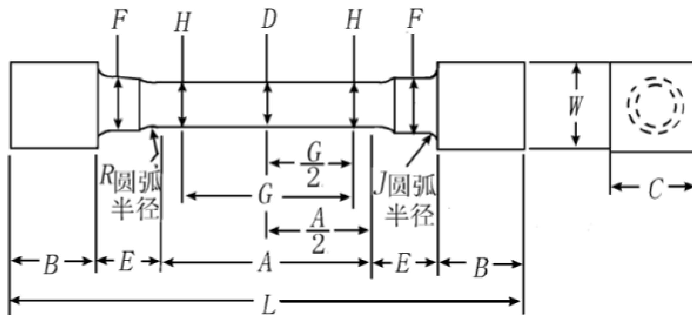
未机加工压实体的大约压制面积=752mm<sup>2</sup>(1.166in<sup>2</sup>)
