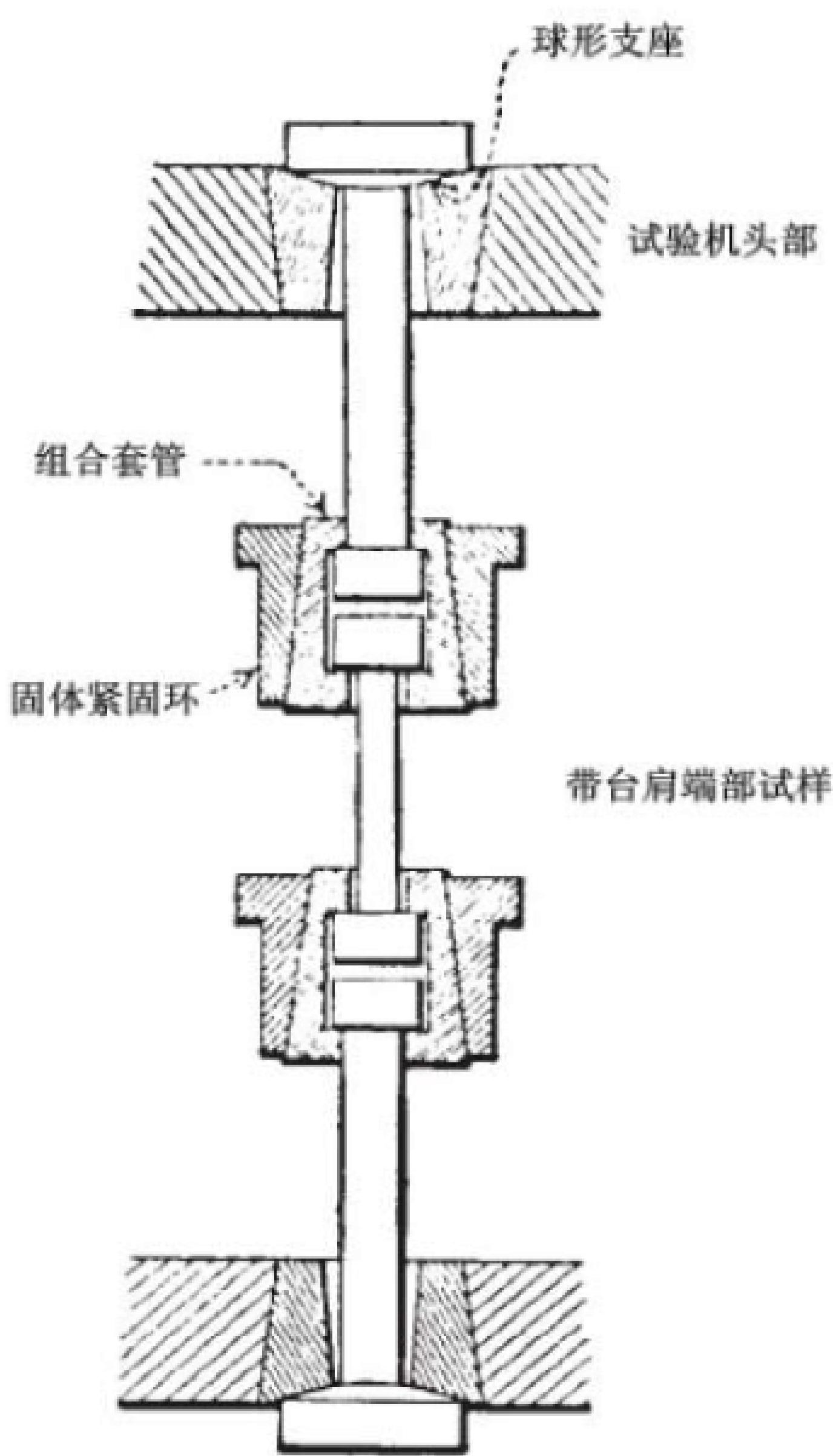
图4 用于带台肩端部试样的夹持装置
