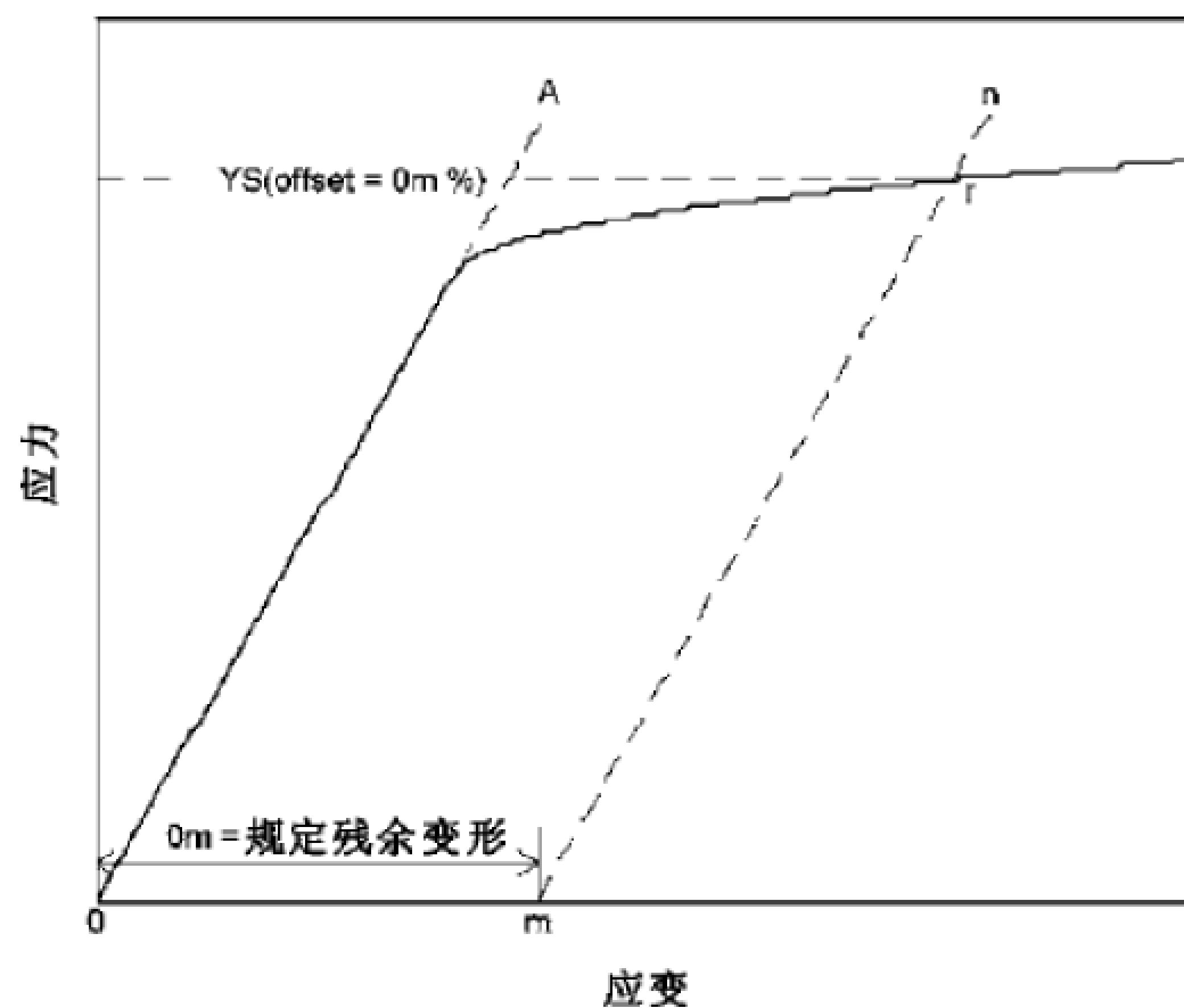
图 21 用残余变形法确定屈服强度的应力-应变曲线
