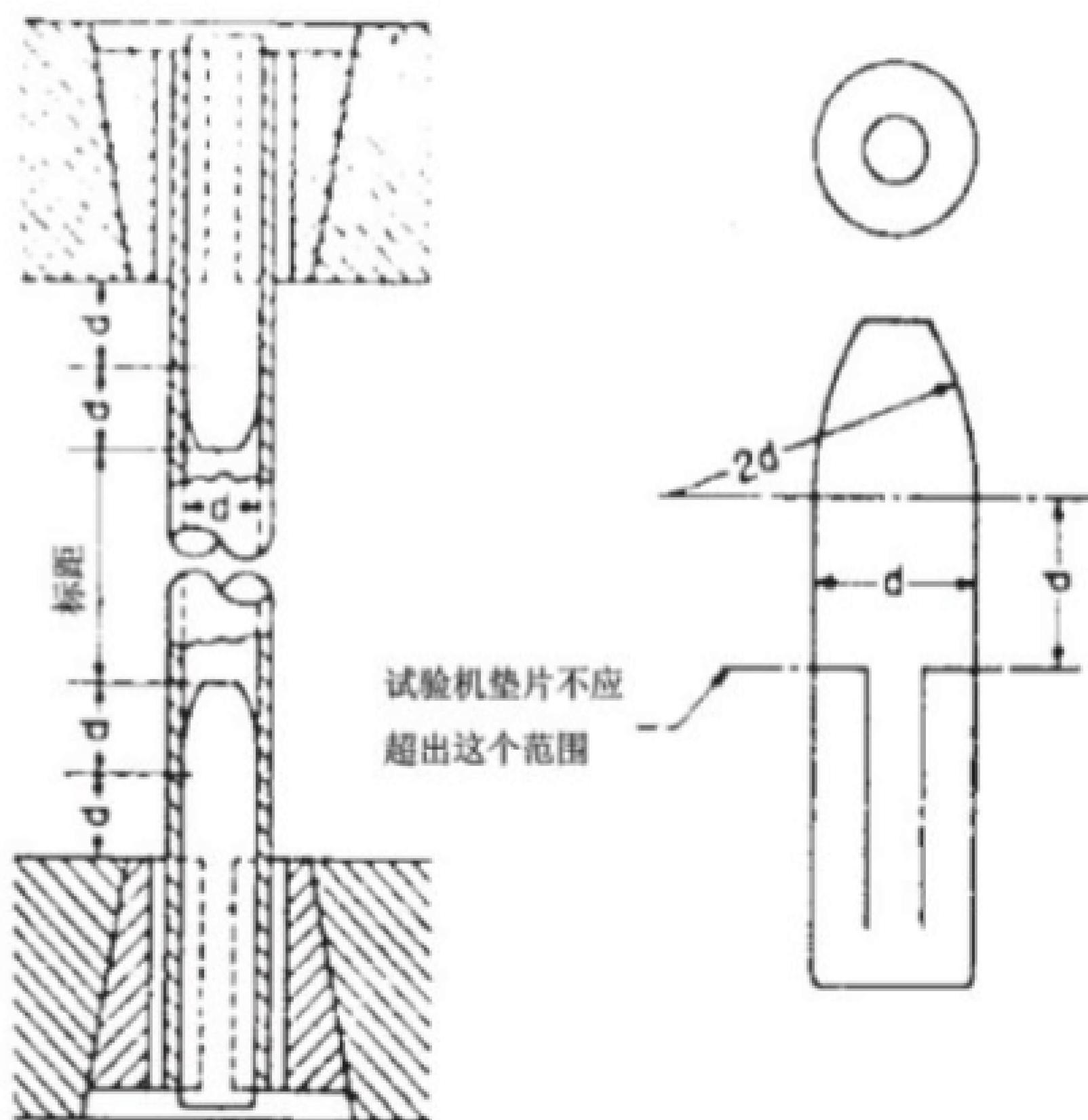
注1——塞头的直径从试验机垫片限定线至弯曲部分应稍有锥度
