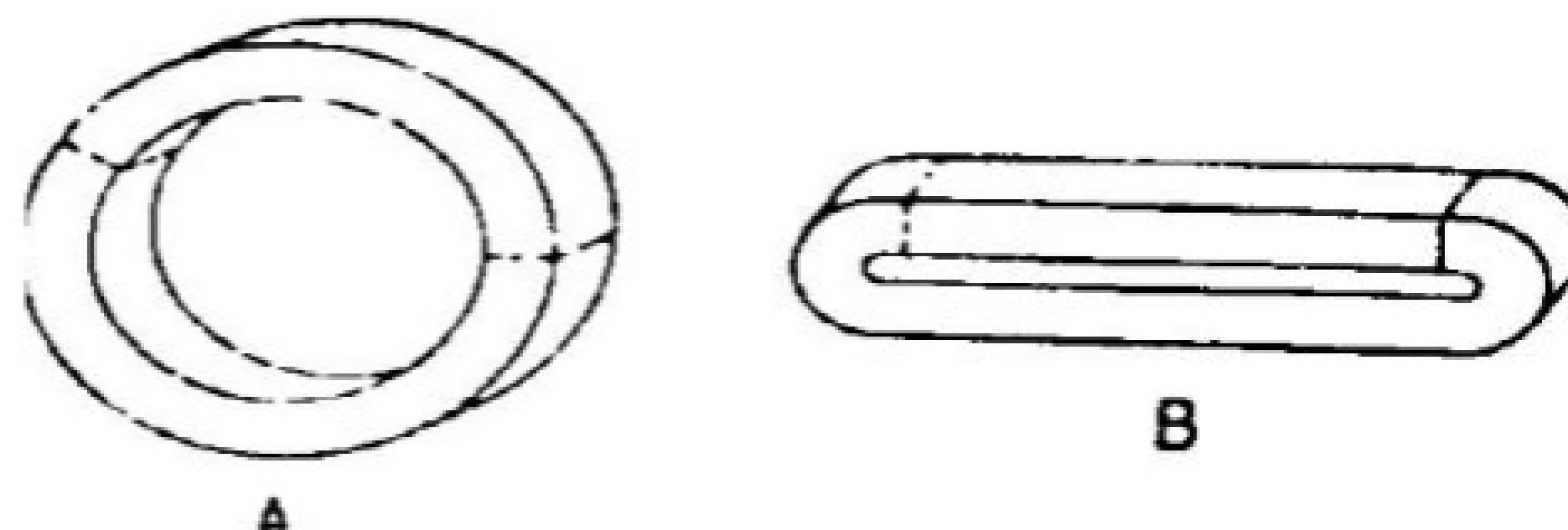
图14 从管产品上切取管环中横向拉伸试样的位置
