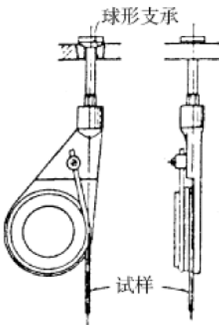
**图 6 用于线材试验的缓冲装置**
