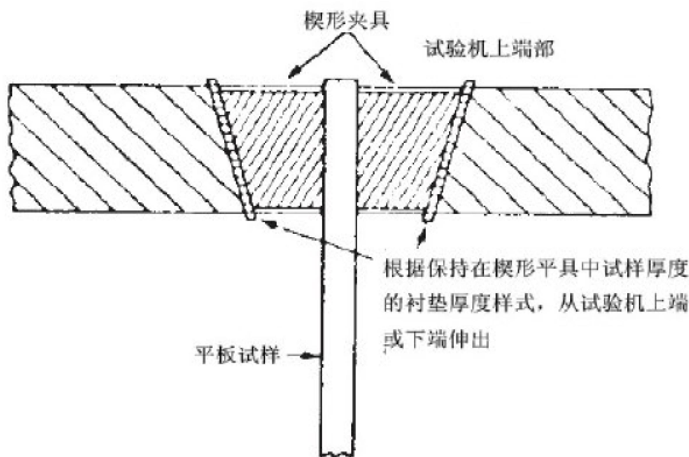
**图2 用于扁平试样的带衬垫的楔形夹具**
