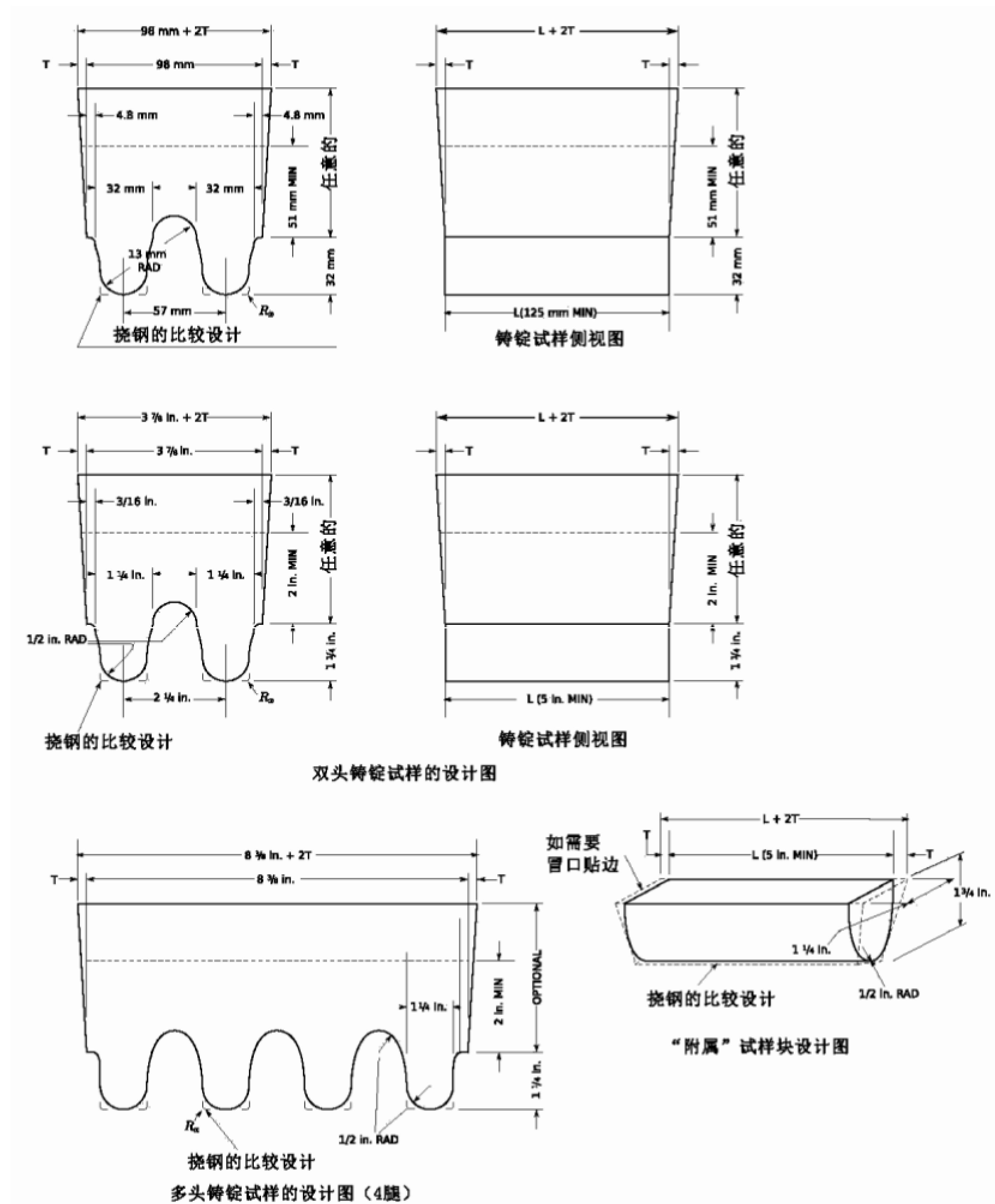
图16 铸造试验块
