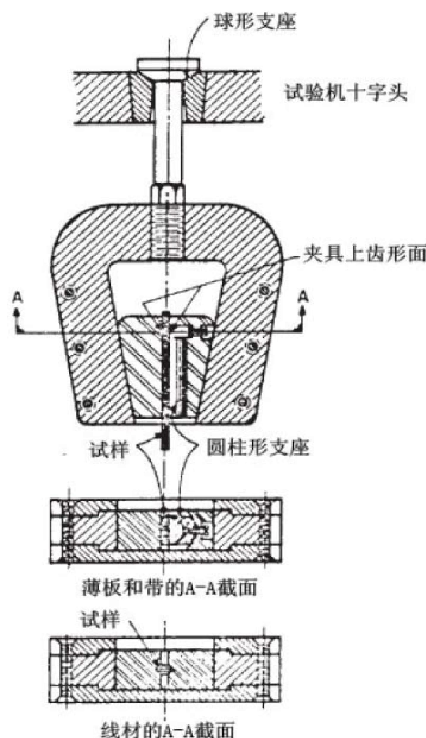
图5 板材和线材试样的夹具
