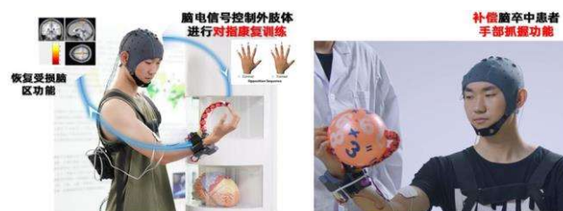
图 40 神工-灵犀指 脑-肌电控外肢体（手部）康复训练机器人
