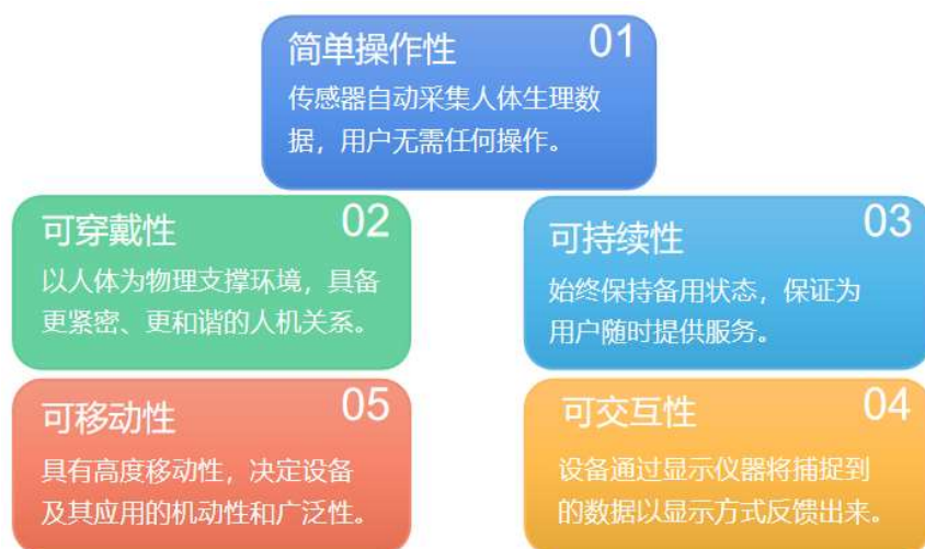
图 19 基于可穿戴设备的感知技术特点
