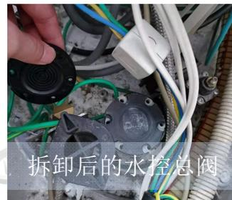
拆卸后的水控总阀
