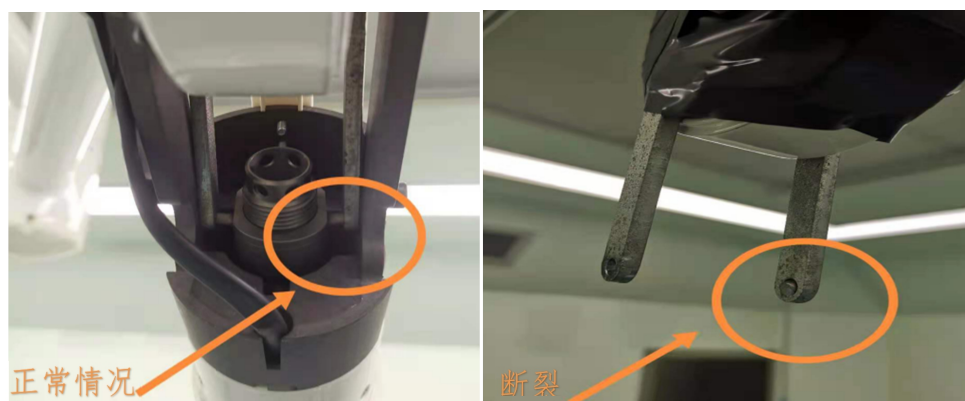
图 25 内置支撑杆连接处部件断裂图
