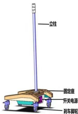
图 7 移动座结构示意图
