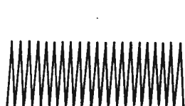
图 7-2-12 CPU 第⑨、⑩脚之间的晶振脉冲正常波形图 图 7-2-13 CPU 第⑤脚输出脉冲的正常波形
