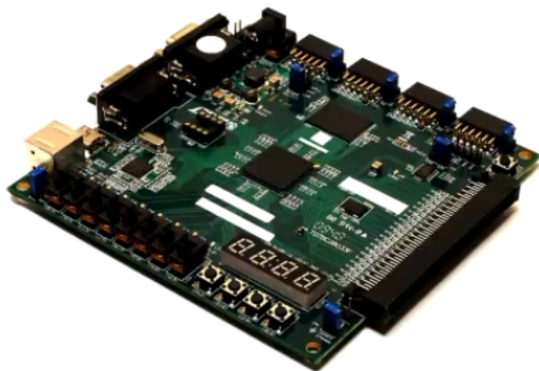
PCBA（PCB空板经过SMT上件， 或经过DIP插件）
