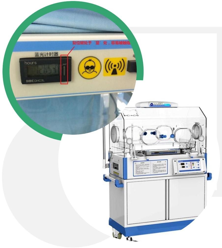
婴儿培养箱蓝光计时器复位按钮突出面板，使用单位在日常清洁过程中，轻微触碰就会触发计时器复位，对比同类型其他产品（复位按钮设计为凹陷或者按钮阻力较大，需用力才可按下）认为可能存在设计缺陷。注册人经过产品风险评价，认定为设计缺陷，修改了产品设计。
