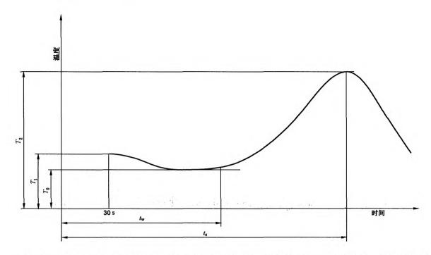
注: 典型的记录曲线表明热电偶刚插入样品内的温度  $T_1$ ,插入后温度轻微下降  $T_0$ ,温度峰值  $T_2$ 。温度开始上升的时间  $t_n$ ,表示固化反应开始,也即工作时间的结束。温度峰值的时间  $t_n$ ,表示固化时间。
